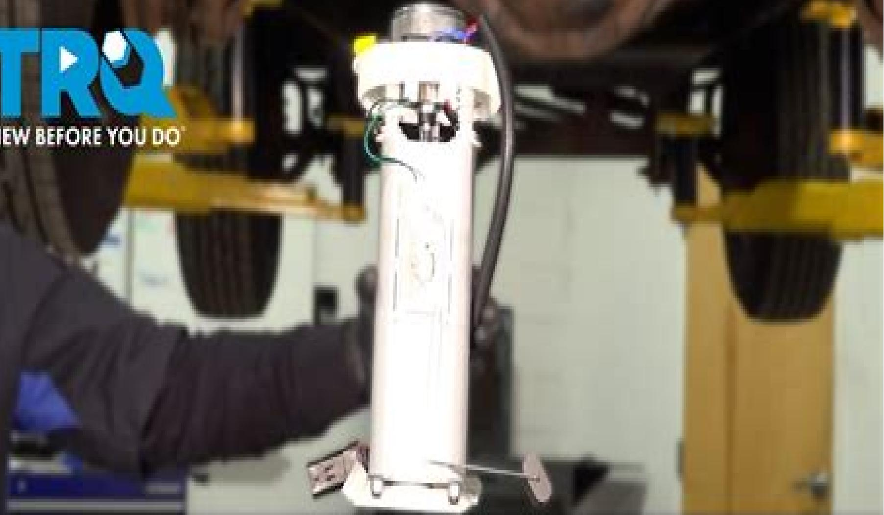
**HOW TO REPLACE FUEL PUMP MODULE ASSEMBLY
