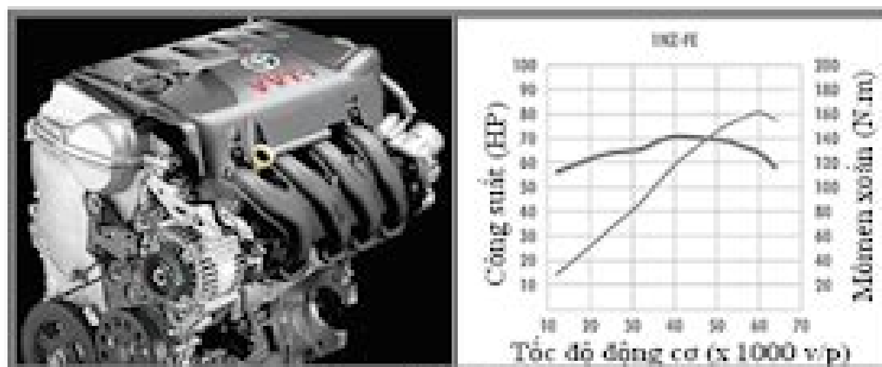
Hình 2.25 Động cơ 1NZ – FE nhìn từ bên ngoài
