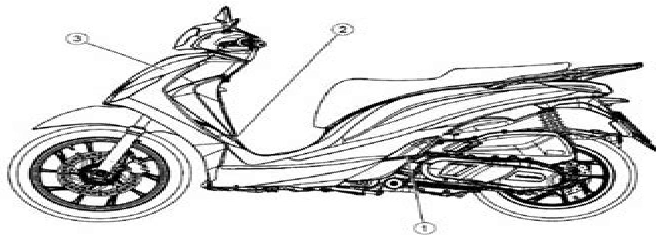
**1. CHASSIS/ENGINE GROUND CONNECTION**
